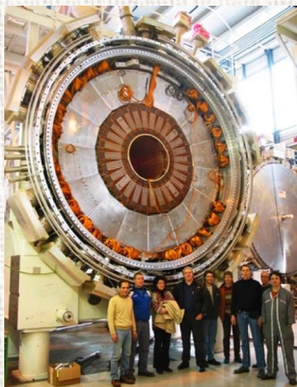
Торцевой калориметр, помещенный в криостат (боковая стенка открыта).
