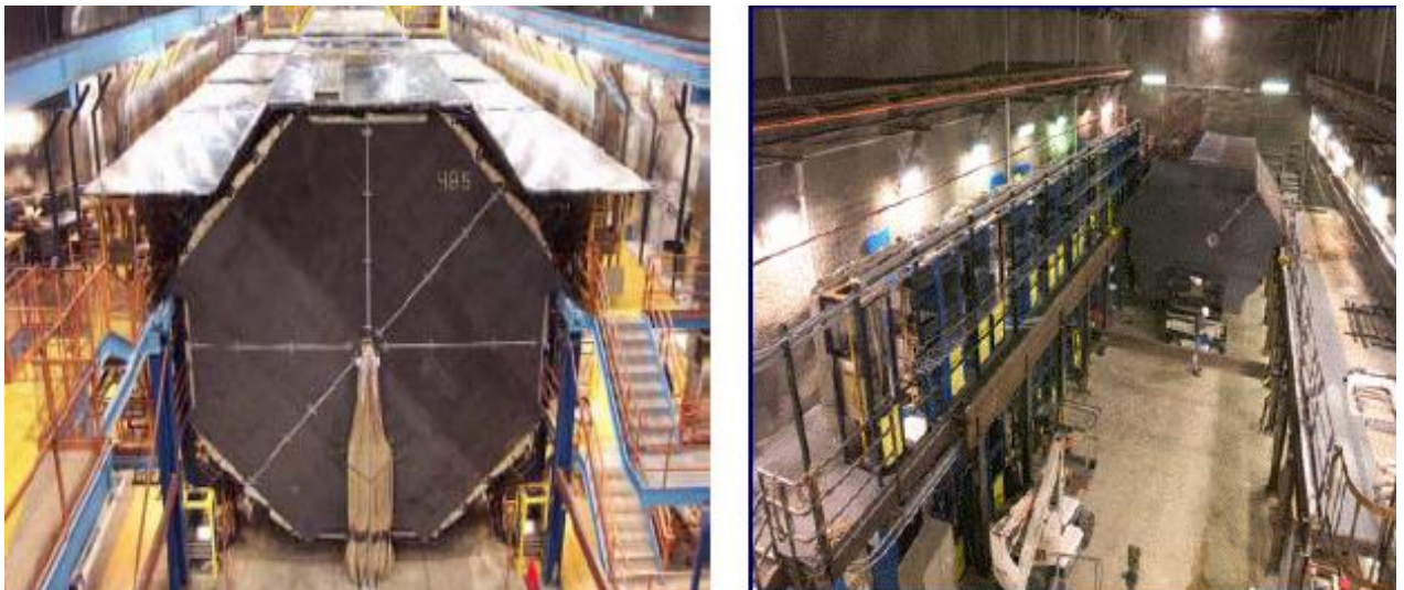
Рис. 24.1. Дальний (слева) и ближний (справа) калориметры MINOS.
