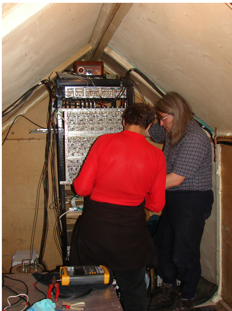
Настройка сотрудниками ФИАН Чубенко А.П. и Щепетовым А.Л. системы регистрации установки на 3500 м н.у.м. для исследования физических процессов в атмосферных молниях.
