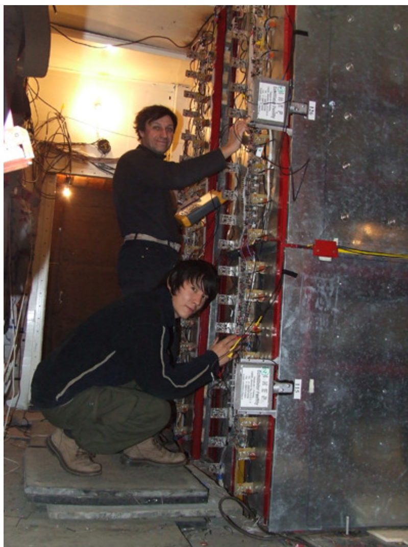
Настройка каналов подземного нейтронного калориметра ( "UNCA-152" ) для регистрации нейтронных «толчков» от горизонтальных мюонов.
