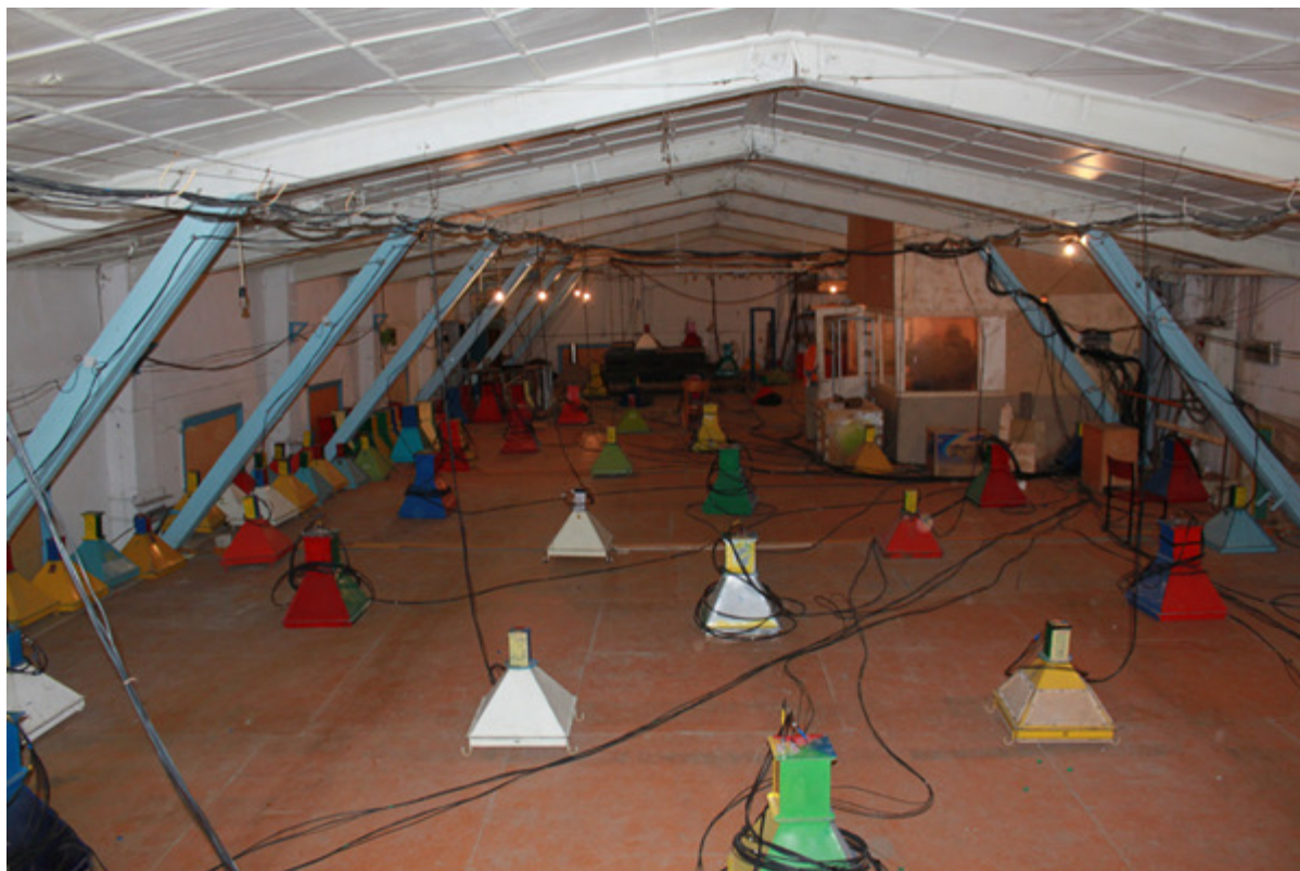
Сцинтилляционные детекторы для регистрации электронно-фотонной компоненты.
