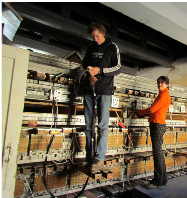
Подземный 2-х секционный нейтронный детектор для регистрации нейтронных «толчков» от вертикальных мюонов.
